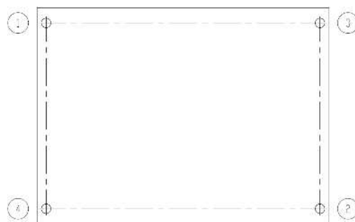
図 4-3 ボルトの締付け順序 (例)
