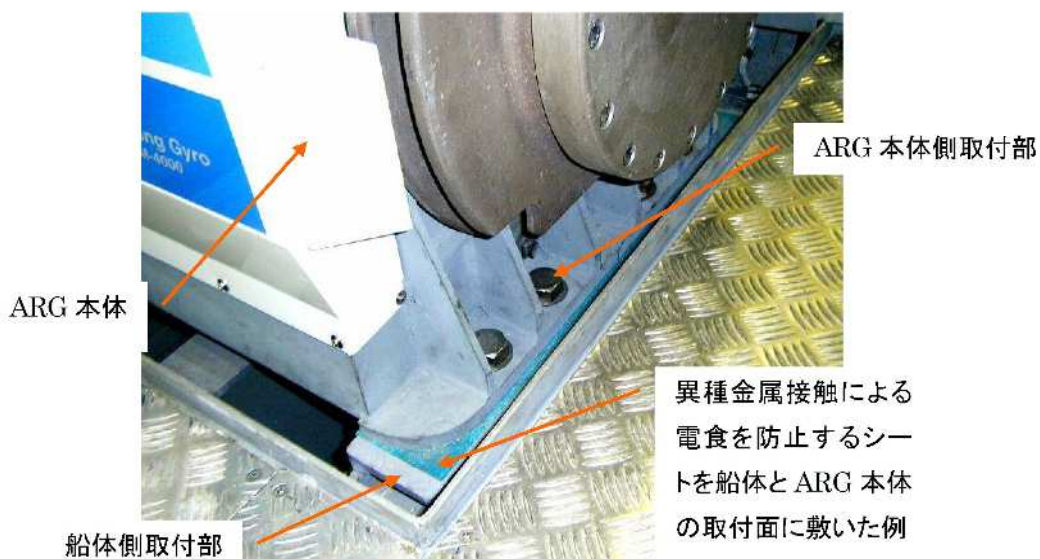
図 4-5 ARG 本体の取付面における電食防止処理の例
